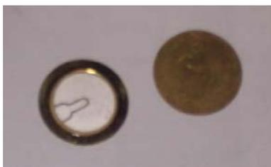
Et oui ces petites pastilles sont les mêmes que l'on trouve à l'intérieur des fûts de batterie électronique le reste c'est le moyen de fixation « la mécanique » et la connectique
