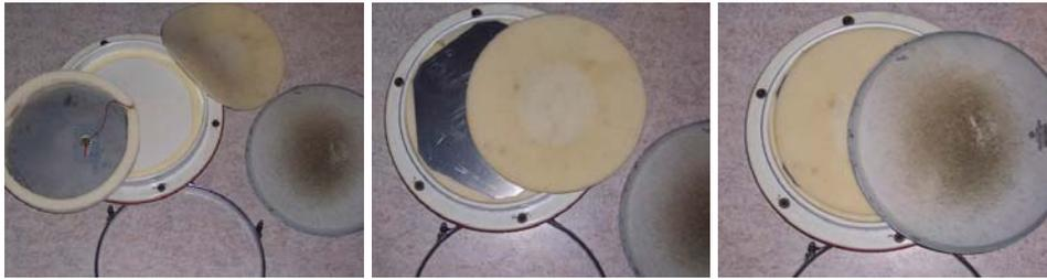
**ph 1** : nous voyons le cercle puis la plaque d alu avec le capteur collé dessus, le fut, la mousse le peau , **ph 2** : on voit la plaque d alu avec la mousse qui va se poser dessus.
